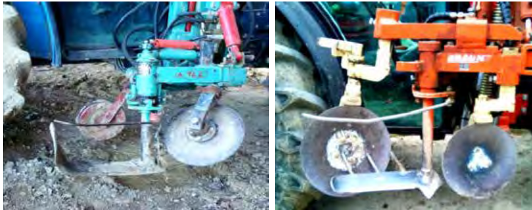
Lamette in posizione ventrale scalzante-rincalzante (versioni tipo vomere o con doppia ruota)
