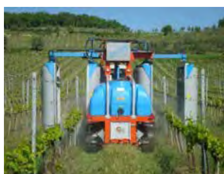
A tunnel con pannelli di recupero
