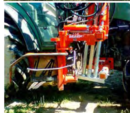
Rasaerba e spollonatrice applicati sul portattrezzi della lametta in posizione ventrale
